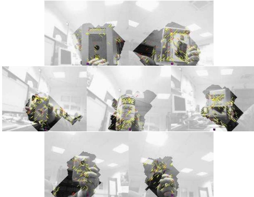
FIG. 5.9 – Objets : La partie masquée par la détection de mouvement apparaît en plus clair. Les marques jaunes marquent les positions des caractéristiques SIFT détectées.
